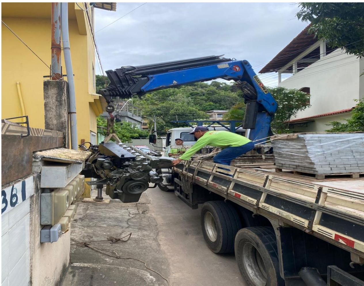
Um **munck** é basicamente constituído de braço e lança, articulados, sapatas estabilizadoras e sistema hidráulico. Contém ainda, bomba hidráulica e acessórios opcionais, escolhido dentro das necessidades de cada operação (exemplos: cestos aéreos, lança suplementar, etc.)
