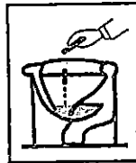
Vazamentos na válvula ou na caixa de descarga.
